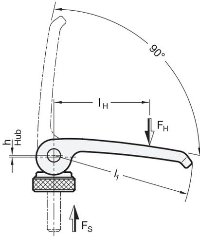
Das Exzenter-Prinzip bietet zwei Vorteile: Eine große erreichbare Spannkraft  $F_S$  bei gleichzeitiger Selbsthemmung nach Überschreiten des Totpunktes.
