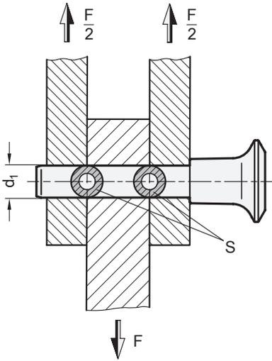
Die in der Tabelle angegebenen Belastbarkeiten für die zweischnittige Scherfestigkeit (Bruchkraft) sind in Anlehnung an die DIN 50141 rechnerisch bzw. theoretisch ermittelt worden.
