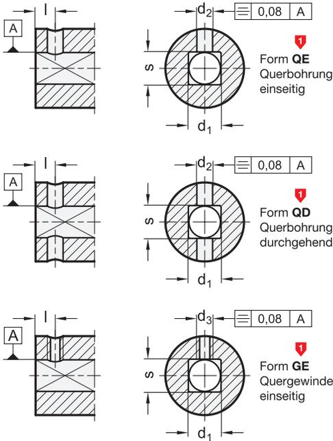
Positionierung der Querbohrung radial und in Bezug auf Nabennut / Vierkant:
